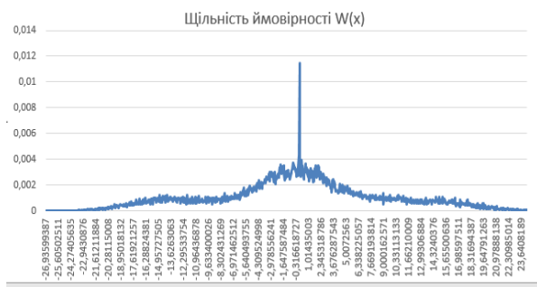
Рис. 18. - Щільність ймовірності схеми Атрактора з наступними параметрами: \text{Rho} = 28, x = 0, y = 1, z = 2000
